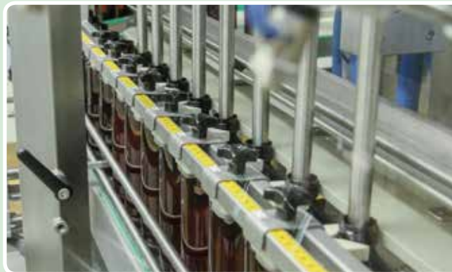
Auf Hochglanz polierter Edelstahl: die neue Abfüllanlage erstreckt sich vom Transfer über das Abfüllen bis zum Verschrauben.
